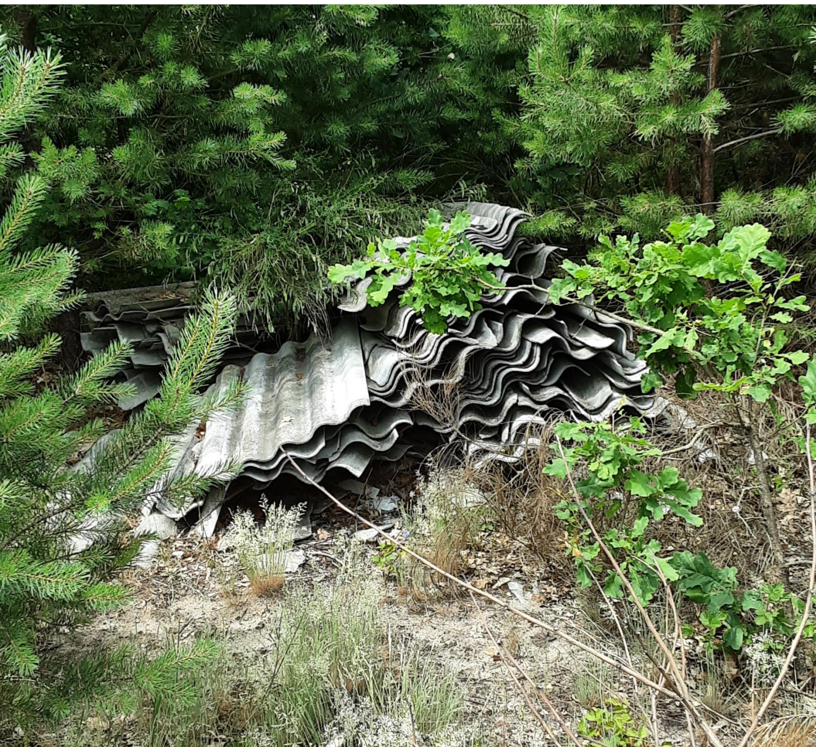
Fot. 3. Nielegalne składowanie wyrobów azbestowych.
