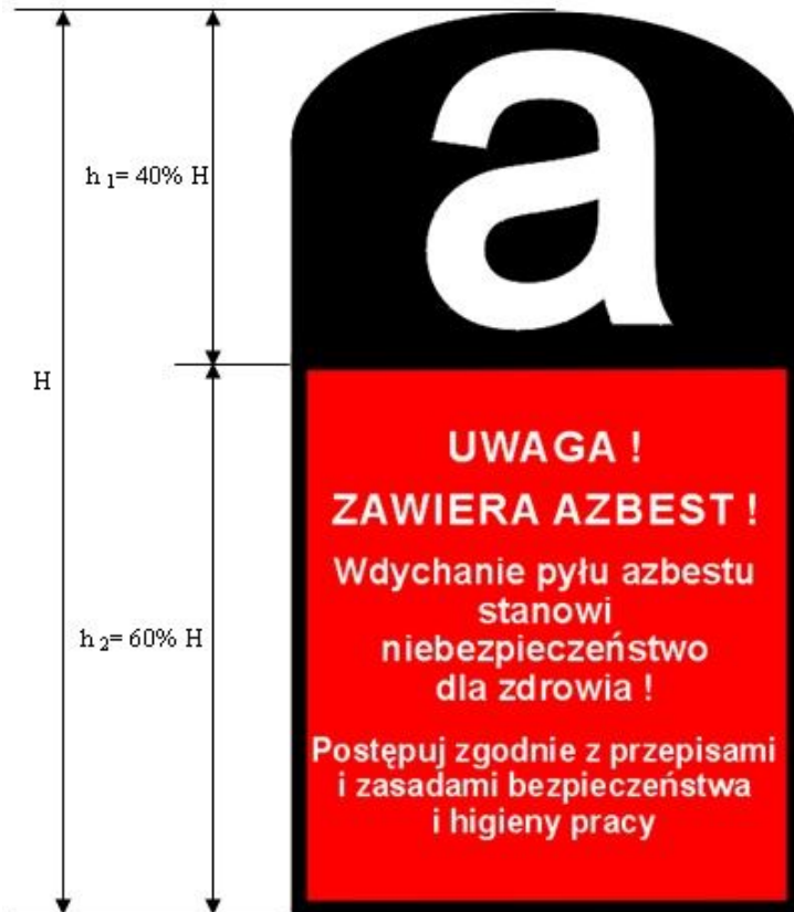
Rys. 3. Wzór oznakowania instalacji lub urządzeń zawierających azbest oraz rur azbestowo-cementowych.
